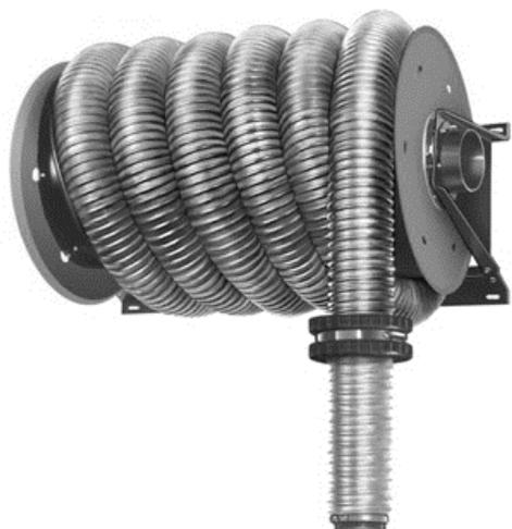
ARROTOLATORI DA FISSARE AL MURO O A SOFFITTO, DA COLLEGARE A IMPIANTO CENTRALIZZATO OPPURE ACCOPPIATI A VENTILATORE. STRUTTURA IN ACCIAIO, DISCHI IN LAMIERA, SISTEMA DI ROTAZIONE CON INGRASSATORE IN LEGA DI ALLUMINIO, QUATTRO TAGLIE DI TAMBURI PER I DIVERSI DIAMETRI E LUNGHEZZE DI TUBAZIONE FLESSIBILE DA 7,5 – 10 – 12,5 – 15 METRI.
