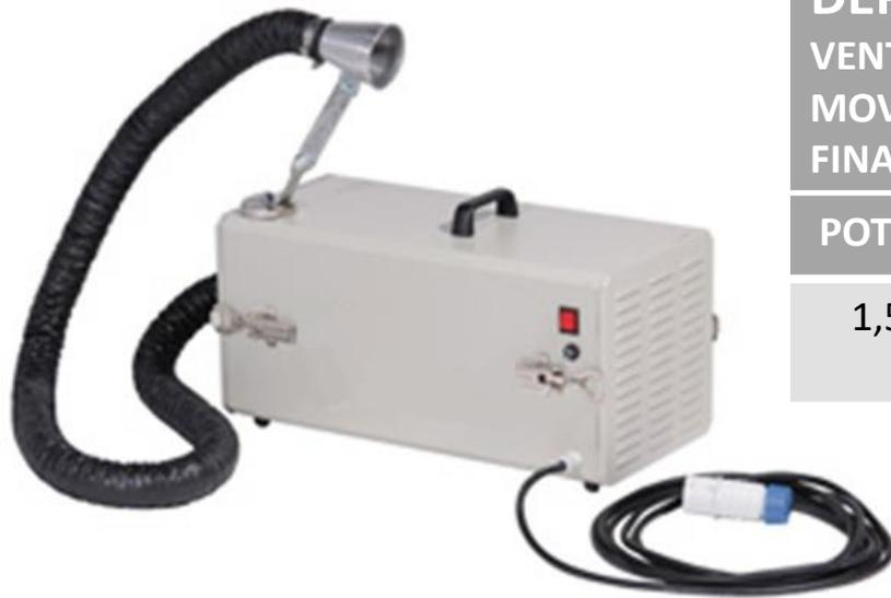
**DEPUR-1 – DEPURATORE PORTATILE PER TORCE ASPIRANTI CON VENTILATORE E TRE STADI DI FILTRAZIONE. COMPLETO DI MANIGLIA DI MOVIMENTAZIONE, 2MT DI TUBAZIONE FLESSIBILE Ø50mm E CAPPETTA FINALE CON ATTACCO MAGNETICO**
