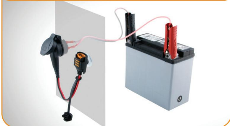
L'esclusivo sistema di connessione magnetica COMFORT-MAG permette di tenere sotto carica la batteria del vostro mezzo senza dover accedere al vano batteria o all'interno vettura, evitando così di avere cavi chiusi nelle portiere o cofani aperti durante la sosta del veicolo. Totalmente stagno e di facile applicazione, può essere utilizzato su tutti i caricabatteria CTEK 12V di potenza fino a 10 Amps (MXS10EC escluso). Disponibile a richiesta anche nella versione 24V.
